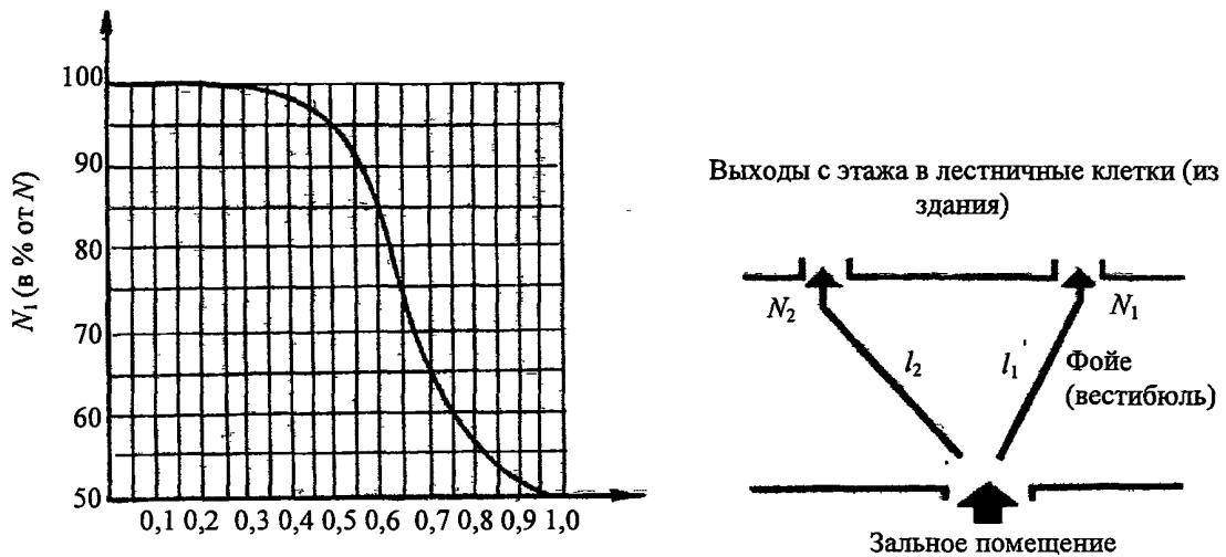
Рис. П5.5, а. Число зрителей и выбор выхода при эвакуации в две лестничные клетки либо в две открытые лестницы или в два выхода из здания:  $N$  – общее количество эвакуирующихся;  $N_1$  – число эвакуирующихся через ближний выход;  $N_2$  – число эвакуирующихся через дальний выход;  $l_1$  – длина пути до ближнего выхода;  $l_2$  – длина пути до дальнего выхода
