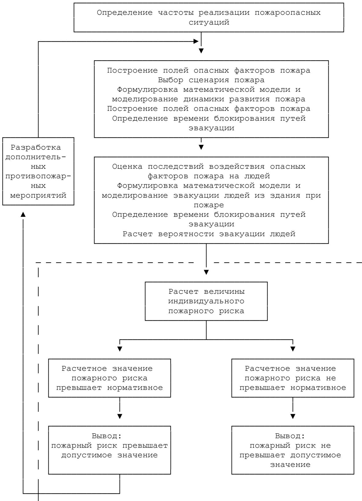
**Рис. 1. Порядок проведения расчета индивидуального пожарного риска**
