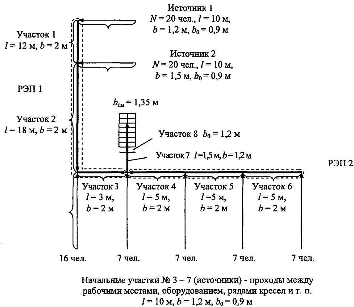
Рис. П5.2. Пример составления расчетной схемы эвакуации людей по части этажа до входа в лестничную клетку:  $N$  – количество людей;  $b$  – ширина;  $l$  – длина;  $b_0$  – ширина проема
