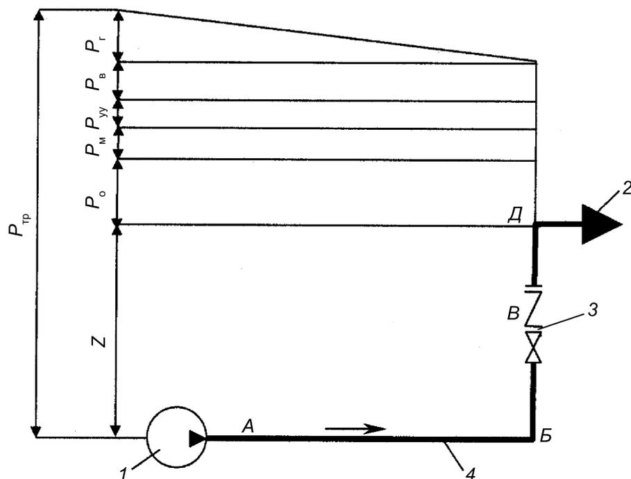
1 — водопитатель; 2 — ороситель; 3 — узел управления; 4 — подводящий трубопровод;  $P_r$  — потери давления на горизонтальном участке трубопровода АБ;  $P_b$  — потери давления на вертикальном участке трубопровода БД;  $P_m$  — потери давления в местных сопротивлениях (фасонных деталях Б и Д);  $P_{yy}$  — местные сопротивления в узле управления (сигнальном клапане, задвижках, затворах);  $P_o$  — давление у диктующего оросителя;  $Z$  — пьезометрическое давление;  $P_{тр}$  — давление требуемое
