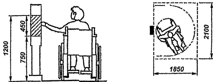
**Рисунок Д.12 – Кассы, телефоны-автоматы, платежные терминалы**
