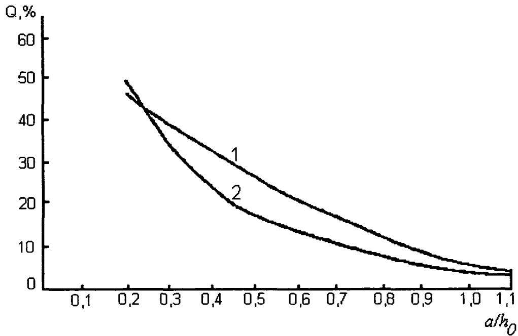
Рис. П3.3. Зависимость доли перелившейся через обвалование жидкости  $Q$  от параметра  $a/h_0$ : 1 - расчет; 2 - эксперимент
