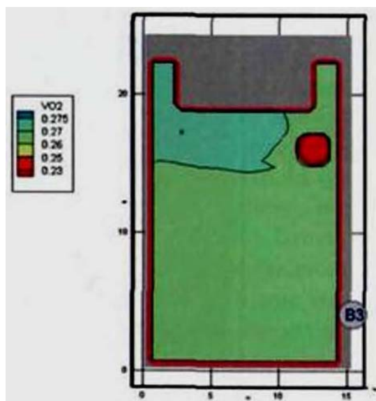
Рис. 96. Концентрация O_2 ( кг/м^3 ) в горизонтальном сечении на высоте 1,7 м от уровня пола в момент времени 410 с
