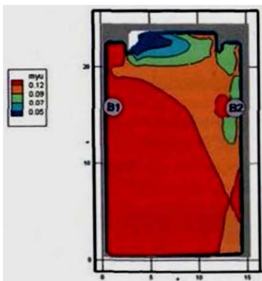
Рис. 87. Оптическая плотность дыма (Нп/м) в горизонтальном сечении на высоте 2,9 м от уровня пола в момент времени 230 с
