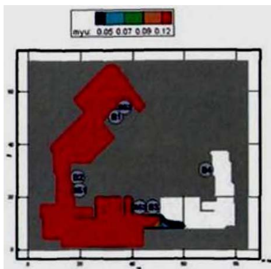
Рис. 144. Оптическая плотность дыма (Нп/м) в горизонтальном сечении на высоте 1,7 м от уровня пола в момент времени 260 с
